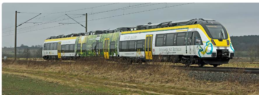
Testfahrt des Battery Electric Multiple Unit (BEMU) auf der Strecke Ansbach – Gunzenhausen, des ersten voll zugelassenen Batteriezugs von Alstom.
